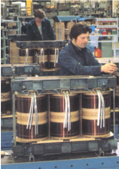
Joonis 3.16. Kolmefaasilise jõutrafo aktiivosa koostamine (vasakul) ja valmis trafo (paremal)
