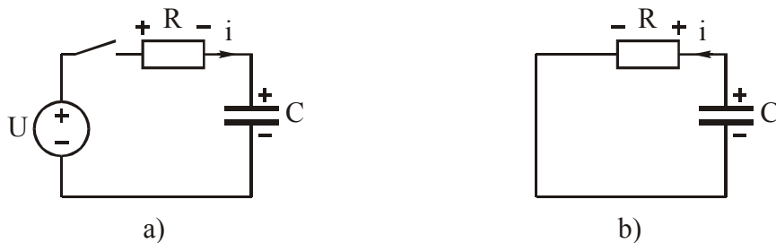
Joon.1.8. Kondensaatori laadimine on passiivtalitus (a) ja tühjendamine on aktiivtalitus (b)
